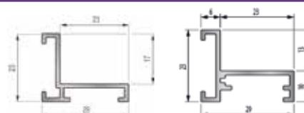
**Rampa d'accesso** 13,5 mm (idonea per tappeti di altezza 14 mm per installazioni direttamente sulla pavimentazione)
