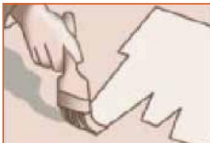
**2.** Sulle superfici porose, sia lisce che ruvide (come legno non verniciato, cemento o pietra), applicare uno strato di primer 3M™ (adesivo per la preparazione delle superfici: adesivo 847/1236 o Primer Scotch-Clad™ 776, o 3M 4475 adesivo trasparente, o 3M 77 adesivo spray trasparente) coprendo l'esatta superficie sulla quale verrà applicata la striscia 3M™ Safety-Walk™.
