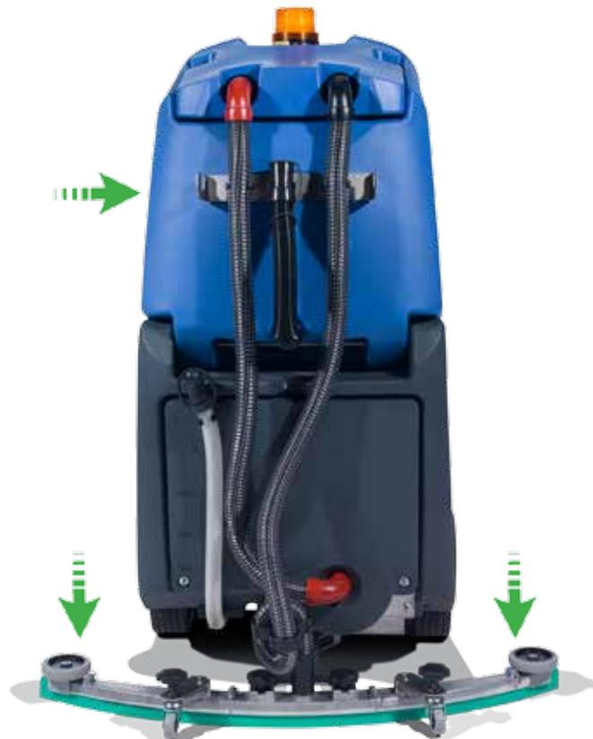
Abbassare il tergilavaggio portando la leva di sblocco nella posizione superiore (Fig. 27).
