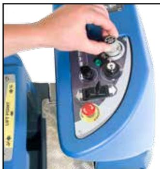
Servendosi della manopola per la regolazione della velocità massima impostare la velocità di spostamento richiesta, a seconda del tipo di pavimento e del livello di sporcizia.
