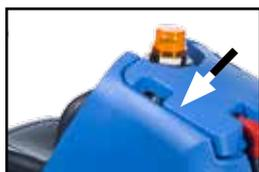
All'interno del serbatoio acqua sporca (superiore) è presente un interruttore serbatoio pieno che provvede ad arrestare la macchina quando il livello dell'acqua sporca raggiunge il limite massimo.
