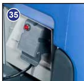
Inserire il cavo di ricarica conforme alle norme locali nella presa di ricarica e collegarlo ad una sorgente di alimentazione idonea (vedere la Fig. 35).
