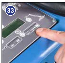
Lo strumento di misura indica il livello di carica delle batterie. Quando completamente cariche, tutte le spie del misuratore sono illuminate (Fig. 33).
