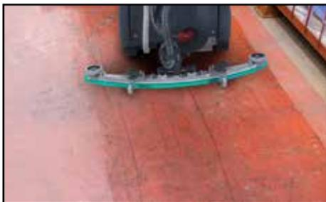
In presenza di striature, pulire le lame del tergipavimento. Su pavimenti molto sporchi, utilizzare la tecnica della "doppia pulitura".
