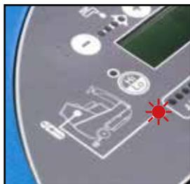
Quando il serbatoio dell'acqua sporca si riempie, sul quadro comandi dell'operatore si accende una spia rossa (come illustrato) e il motorino di aspirazione si arresta automaticamente. Il serbatoio dell'acqua sporca deve essere svuotato (vedere a pagina 16).
