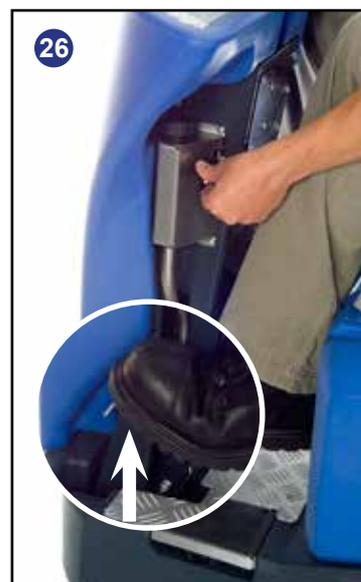
Dopo aver preparato il pavimento (vedere la sezione precedente), impostare i comandi in funzione delle condizioni di pulizia. Prima di applicare le impostazioni, verificare che il gruppo spazzole sia stato abbassato. Mentre si preme il pedale di sinistra (vedere la Fig. 24), premere la leva di sblocco (vedere la Fig. 25) e rilasciare delicatamente il pedale per abbassare il gruppo spazzole (vedere la Fig. 26).
