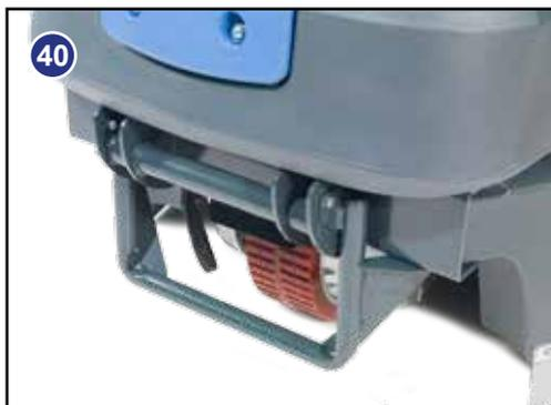
Per il traino della macchina, verificare che la barra di traino sia di tipo adeguato. Prestare particolare attenzione durante il traino: la velocità massima non deve superare i 7 km/h. La macchina può essere trainata dalla barra anteriore, come indicato (vedere la Fig. 40).
