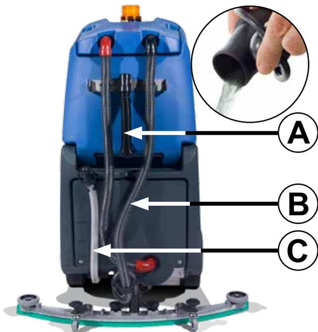
Dopo l'uso, svuotare il serbatoio dell'acqua sporca utilizzando il flessibile di drenaggio e risciacquare con acqua pulita. **(A)**
