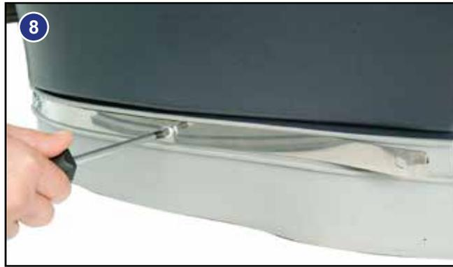
Per montare le protezioni gondole laterali, rimuovere prima le fascette metalliche di ritegno già fissate alla gondola (Fig. 7). Allineare la fascetta metallica di ritegno nelle scanalature di posizionamento sul riparo in gomma e rimontarla utilizzando le viti presenti (Fig. 8).
