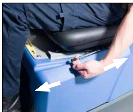
Sedendo in posizione di guida, regolare il sedile in avanti o indietro secondo necessità utilizzando la leva posta sul lato sinistro (vedere la Fig. 23).
