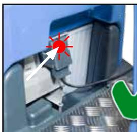
Ricaricare completamente la macchina dopo il suo ultimo utilizzo. Non lasciare la macchina con batteria scarica.
