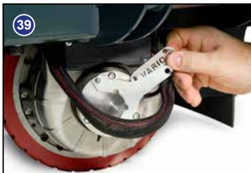
Una volta che la chiave è stata inserita (vedere la Fig. 39), il freno motore è completamente disinserito. La macchina si trova ora in modalità ruota libera completa.
