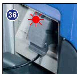
Dopo che il cavo di ricarica è stato collegato, l'indicatore di ricarica rosso si illumina (Fig. 36), sul pannello del display compare la scritta "INHIBITED" (Inibita) e la spia che indica il livello di carica della batteria lampeggia all'unisono.
