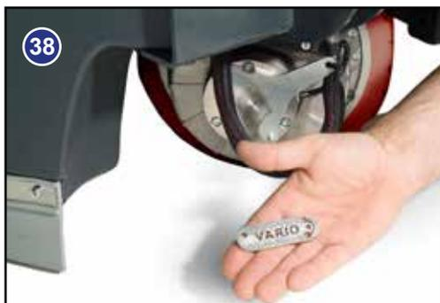
Il kit di avviamento contiene una chiave per lo sgancio della leva freno (329945, vedere la Fig. 38) che può essere inserita tra la leva freno e l'alloggiamento di trazione (vedere la Fig. 39).
