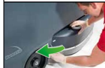
**Innovativo sistema a spazzola ottagonale OBS (Octagonal Brush System); Le spazzole si inseriscono semplicemente a pressione sui supporti semplificando al massimo il processo di montaggio e rimozione.**
