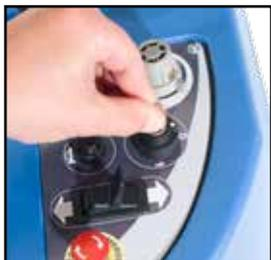
Inserire la chiave nell'accensione e ruotarla di un quarto di giro in senso orario portandola nella posizione "ON" (1). L'indicatore del livello di carica della batteria si illumina.
