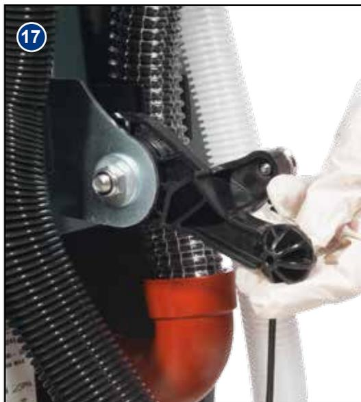
Dopo aver preparato il pavimento (vedere la sezione precedente), impostare i comandi in funzione delle condizioni di pulizia. Prima di applicare le impostazioni, verificare che il gruppo spazzole sia stato abbassato. Azionare la leva del tergilavaggio (vedere la Fig. 17), portandola in posizione abbassata (vedere la Fig. 18).
