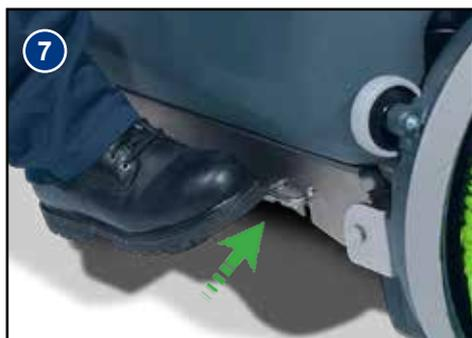
Per ruotare il gruppo verso il basso (modalità operatore). Premere il perno di ritegno del gruppo spazzola (Fig. 7) e ruotare quest'ultimo (Fig. 8).
