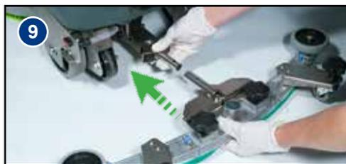
Montare il tergipavimento e bloccarlo per mezzo del perno di ritenuta (Fig. 9).
