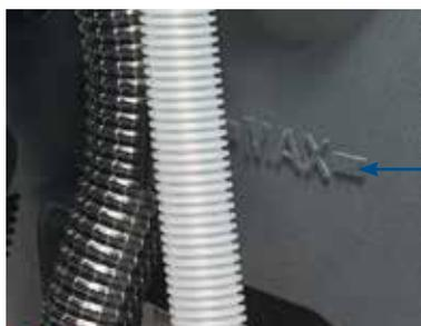
Il livello dell'acqua nel serbatoio dell'acqua pulita può essere rilevato servendosi del flessibile di scarico trasparente posto sul retro della macchina.
