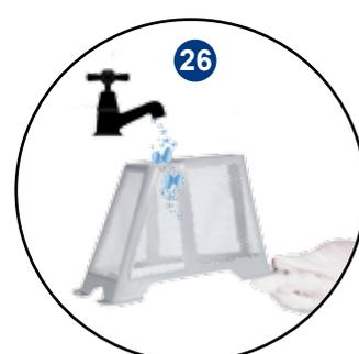
Rimuovere il filtro inserito nel separatore e sciacquare con acqua pulita (Fig. 23) (Fig. 24).
