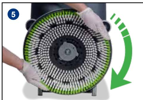
Montare la spazzola / pattino sul supporto, ruotare per bloccare la spazzola (Fig. 5) o il pattino (Fig. 6).
