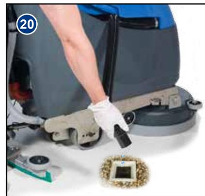
I modelli della serie TT sono stati progettati tenendo a mente la facilità di utilizzo, montaggio e pulizia. Dopo l'uso, svuotare il serbatoio dell'acqua sporca utilizzando il flessibile di drenaggio e risciacquare con acqua pulita (Fig. 20).
